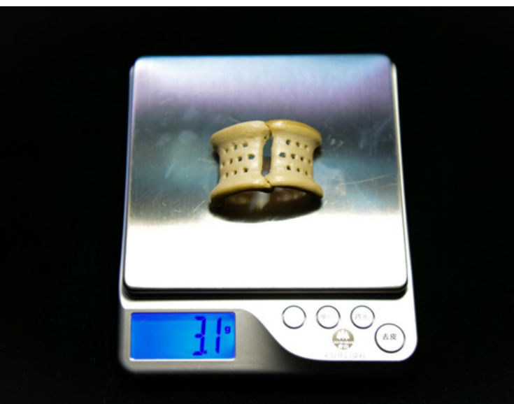
图：INTAMSYS FUNMAT HT 打印的 PEEK 植入体
